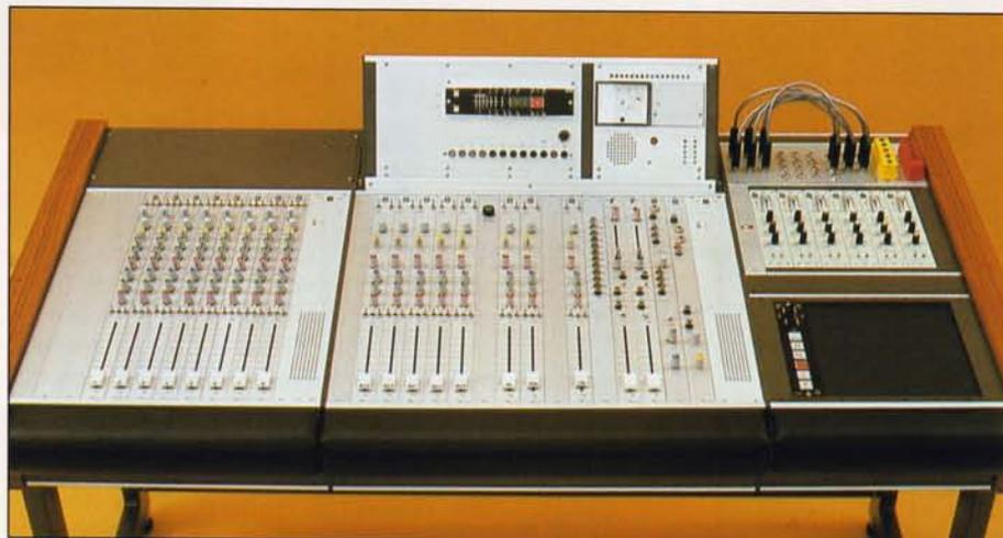
Mit diesem Pult produziert eine bundesdeutsche Rundfunkanstalt Werbespots. Es enthält 8 Mikrofoneingänge und 8 Stereoeingänge.
